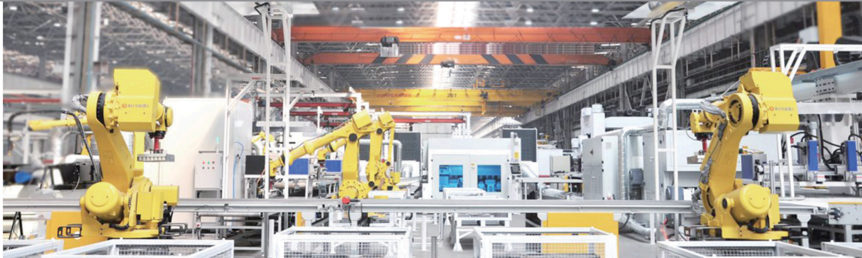
落地三一重工18号厂房的钢板切割下料智能分拣产线。组图/受访单位提供
