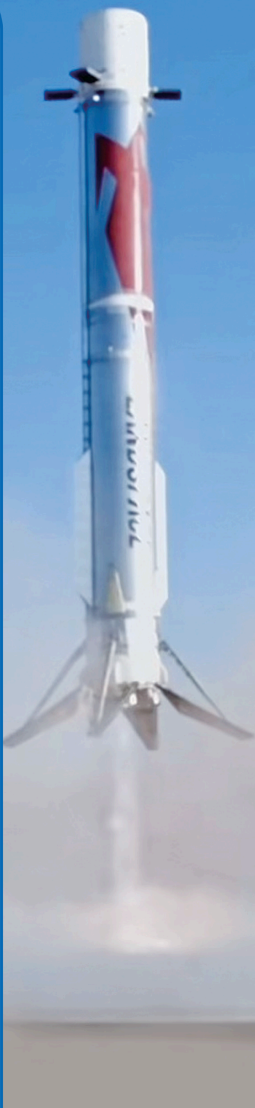
▲8月19日，视频截图显示朱雀三号遥二运载火箭一子级在着陆过程中展开着陆支腿，正在着陆。
