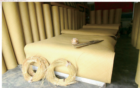
►水竹凉席经 剖、取、刮、煮、晒、 晾、编等纯手工工 序制作而成。 图/益阳日报
